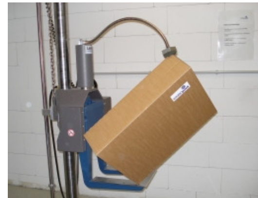
Test de caída
