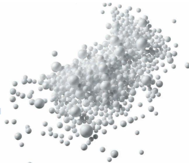
El **poliestireno expandido (EPS)**, también conocido bajo el nombre de marca Styropor®, tiene múltiples usos y es especialmente ligero, ya que se compone de aire en un 98%. El EPS absorbe la energía de impacto y ofrece un buen aislamiento térmico.
