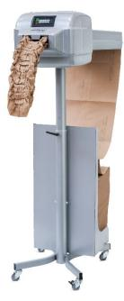
El nuevo sistema de almohadillados de papel PAPERplus® Track produce almohadillados de papel en tan solo unos segundos directamente en la estación de embalaje, proporcionando un almohadillado muy efectivo y reduciendo el material utilizado. **Imagen: Storopack**
